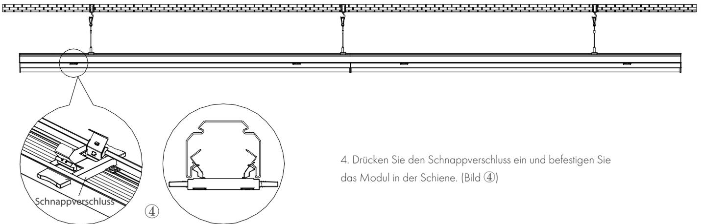
4. Drücken Sie den Schnappverschluss ein und befestigen Sie das Modul in der Schiene. (Bild ④)
